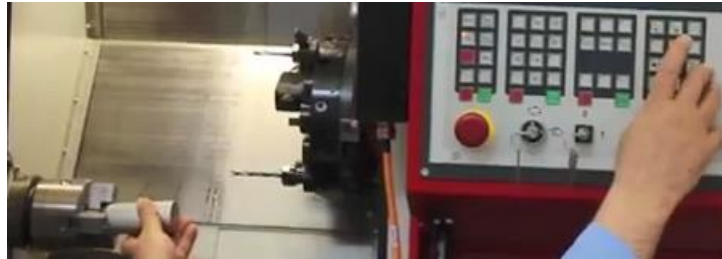
شكل رقم ٧٧: تثبيت الشغلة بالظرف
