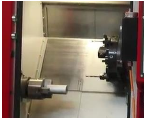
شكل رقم ٧٨: الشغلة بعد التثبيت في الظرف
