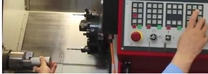
شكل رقم ١٢: تثبيت الشغلة بالظرف
