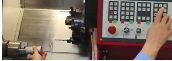
شكل رقم ٥٣: تثبيت الشغلة بالظرف
