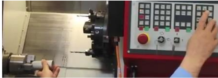
شكل رقم ٢٩: تثبيت الشغلة بالطرف
