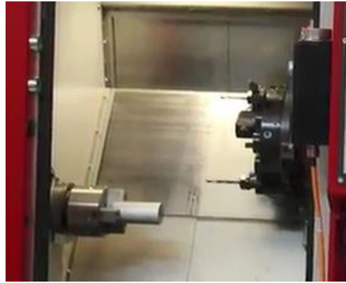
شكل رقم ١٣: الشغلة بعد التثبيت في الظرف
