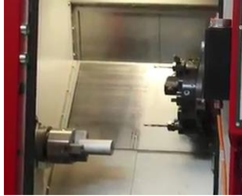
شكل رقم ٦٦: الشغلة بعد التثبيت في الظرف
