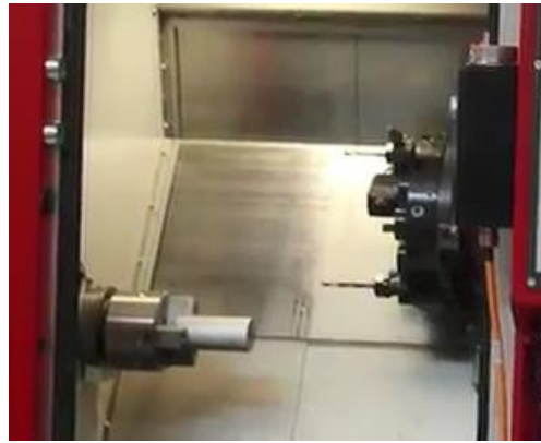
شكل رقم ٥٤: الشغلة بعد التثبيت في الظرف
