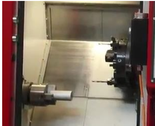
شكل رقم ٧٢: الشغلة بعد التثبيت في الظرف
