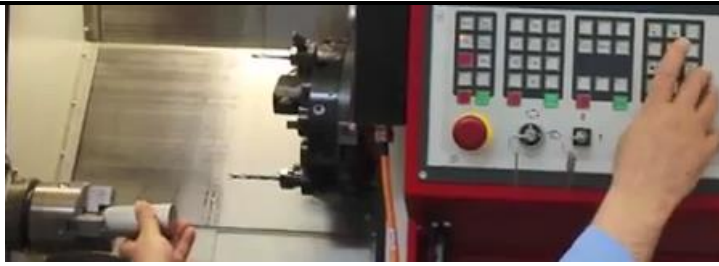
شكل رقم ٦٥: تثبيت الشغلة بالظرف
