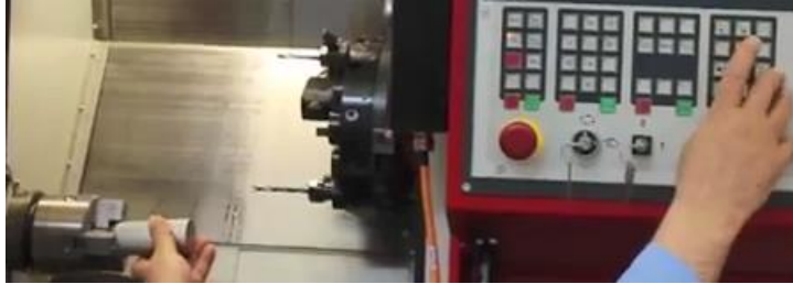
شكل رقم ٧١: تثبيت الشغلة بالظرف
