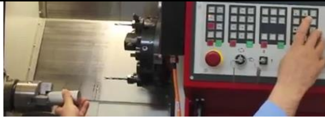
شكل رقم ٥٨: تثبيت الشغلة بالطرف
